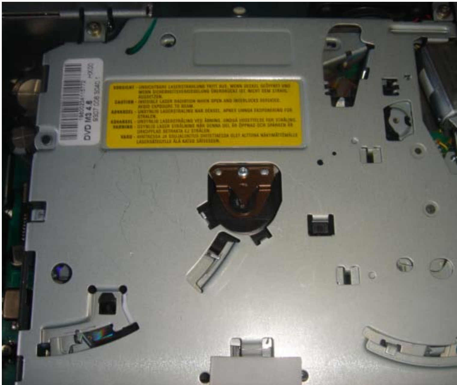
Esta es una imagen más próxima del motor y donde podemos ver el engranaje que vamos a accionar manualmente para poder sacar el CD.
