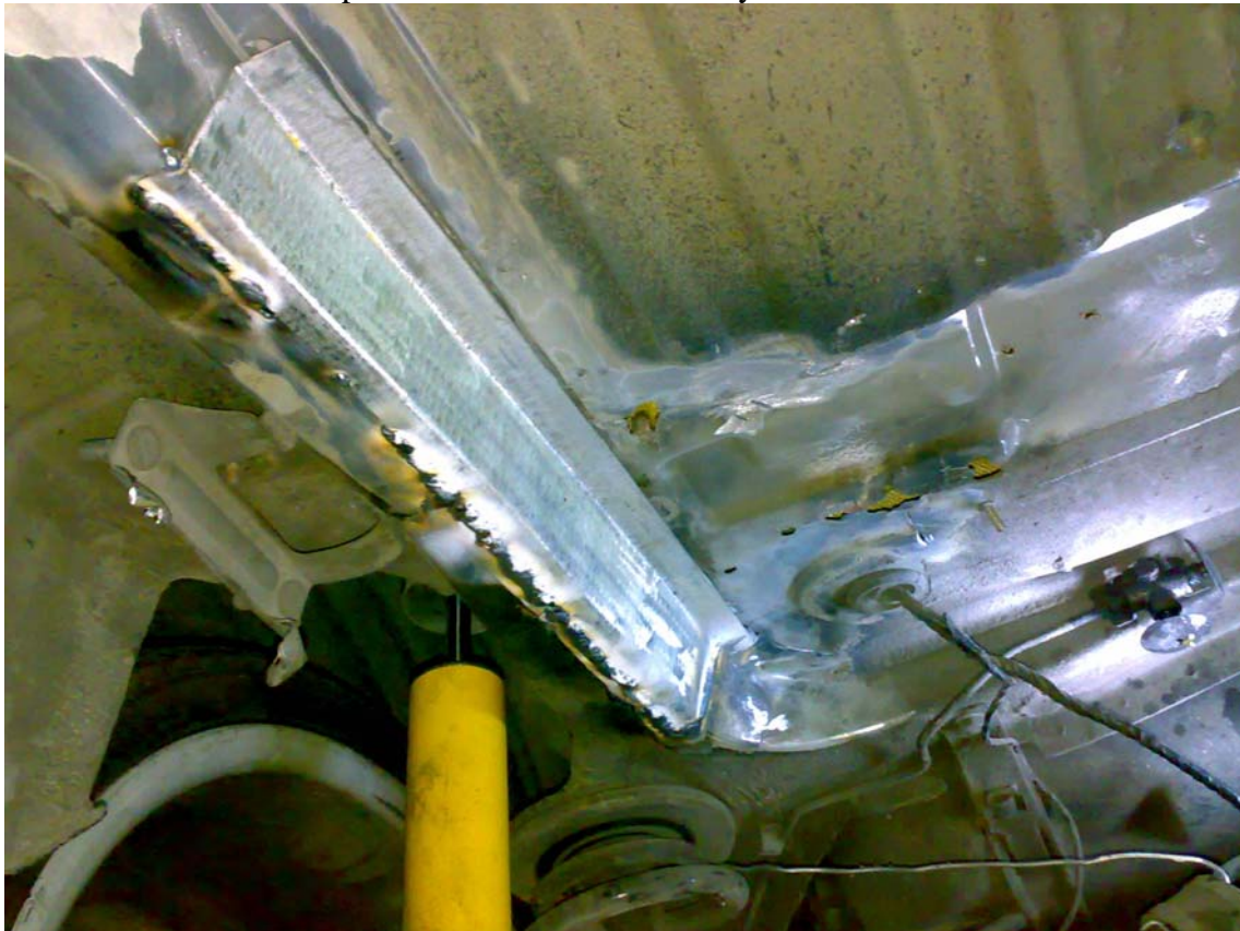
En esta otra foto se ve como el chapista le puso un refuerzo a chasis del coche por estar un poco dañado.
