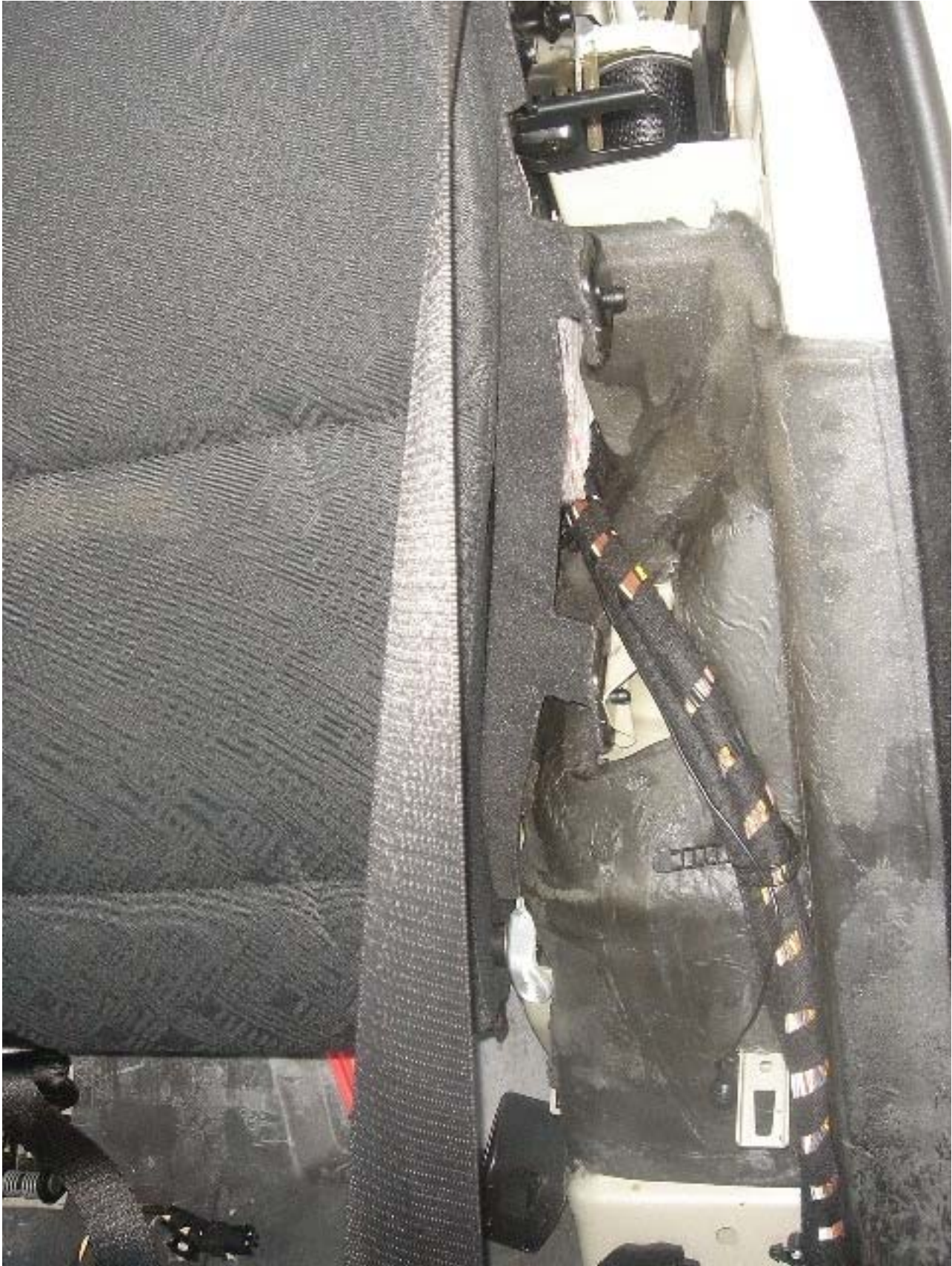
la moldura del micrófono no está situada en el lado del conductor, sino en el del acompañante, la referencia de dicha moldura es: 51448250108 y su precio 2,94€+iva aquí una foto de donde va puesta y cómo es el soporte, dentro se sujetó el micrófono del parrot:
