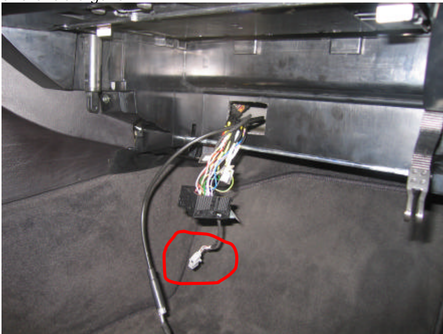
Detalle final con cables extendidos (ISO + antena de radio y entrada auxiliar audio (marcado en rojo)
