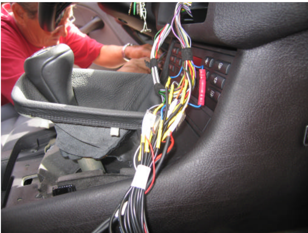
Detalle mazo cables alargado. El color amarillo es el del canutillo termoretráctil
