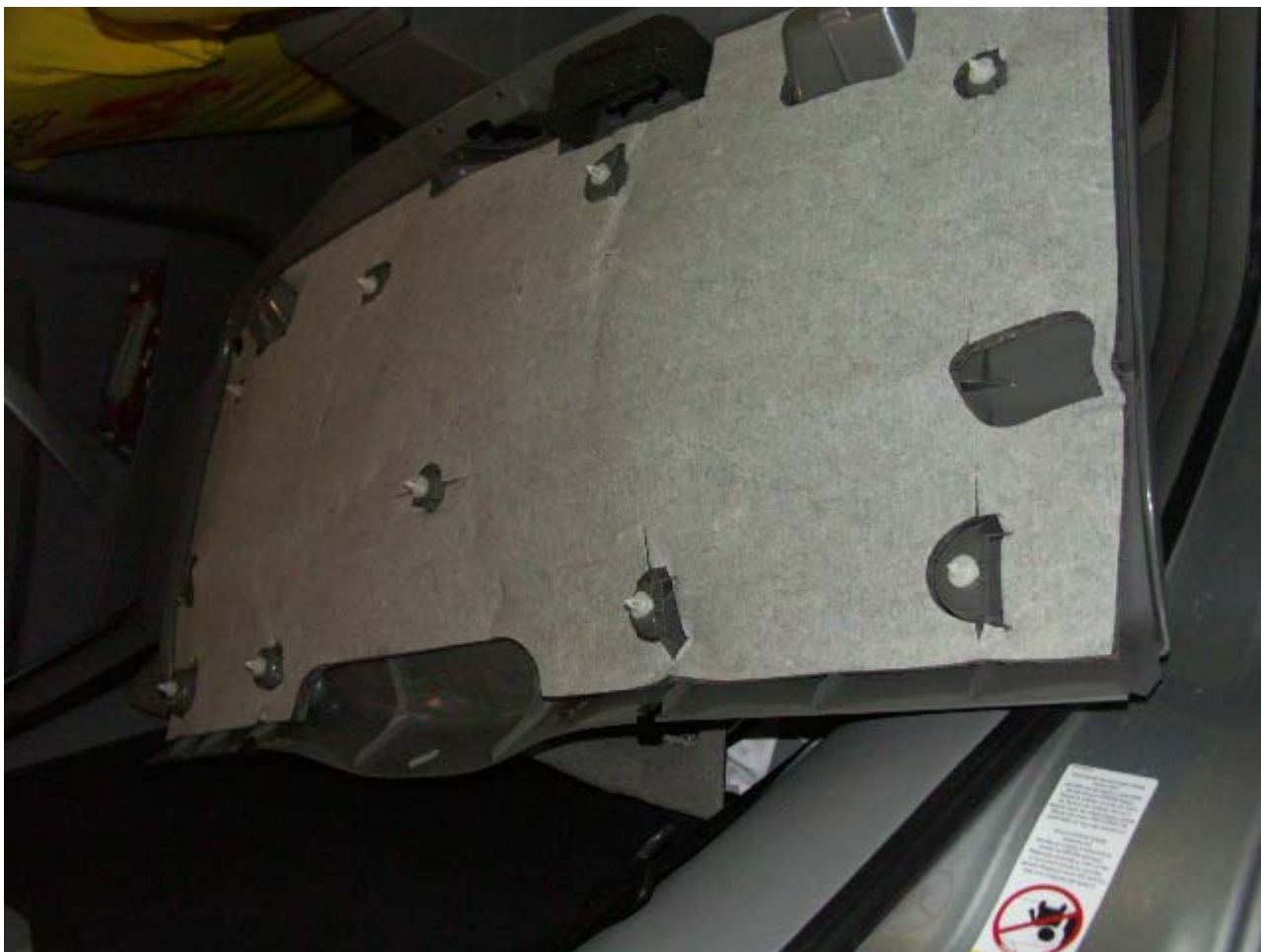
Y aquí como queda el revestimiento una vez quitado con los remaches.
